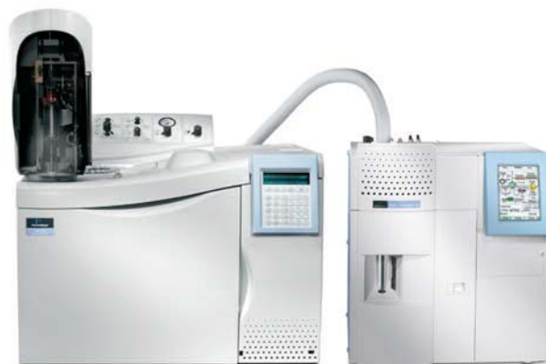
Clarus 400 GC (слева) с TurboMatrix 100 TD (справа).
