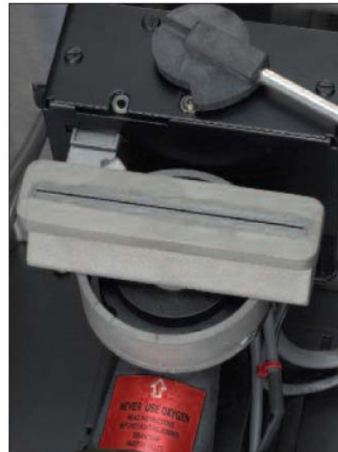
Рис. 3. 10-см прочная титановая головка горелки быстро прогревается и поддерживает стабильное пламя. Также для анализа сложных элементов доступна 5-см горелка для ацетилена/закиси азота.
